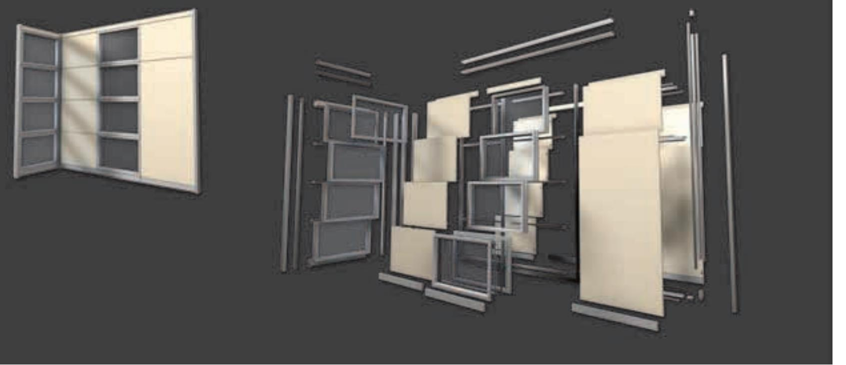
**(IT)** Parete divisoria mobile realizzata con struttura metallica e rivestita con pannelli in truciolo nobilitato melaminico, telai vetri o porte. Lo spessore complessivo è di 102 mm.
